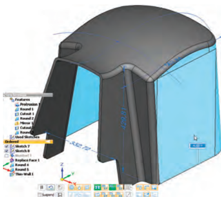
Figure 3. Les opérations Ordonnées, telles qu'une surface stylisée, sont ajoutées à un modèle Synchrone. Des modifications précises peuvent être réalisées en modifiant les cotes ou en glissant les faces ; les courbes guide de type BlueDots peuvent être manipulées en éliminant le besoin de comprendre la création du modèle avant sa modification.
