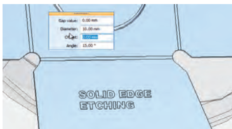
Figure 14. Il y a plus d'options de raccordement des coins, telles que ces formes en U. La commande Gravure permet de brûler les numéros de pièce sur les modèles pendant les opérations de découpe au laser.
